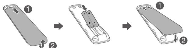
Schiebe den Batteriefachdeckel in Pfeilrichtung, bis er vollständig entfernt ist. Lege 2 AAA-Batterien (1,5 V) mit korrekter Polarität ein. Schiebe den Batteriefachdeckel wieder in Position.
